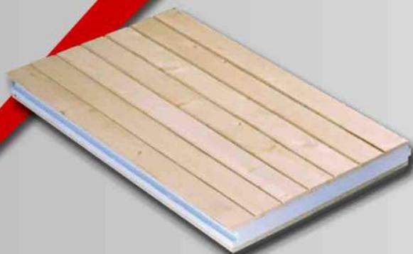
Panel compuesto por una cara de friso de abeto, núcleo de poliestireno extruido y cara superior de aglomerado hidrófugo. La madera usada es de gran calidad y le confiere un alto valor estético.
